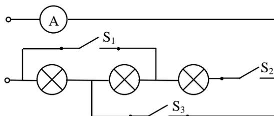
2. До електричного кола прикладена напруга 6,3 В. Кожна лампа споживає струм 0,26 А при 6,3 В. Які вимикачі потрібно ввімкнути, щоб усі три лампи були з'єднані послідовно? Яку силу струму при цьому покажуть амперметр?
