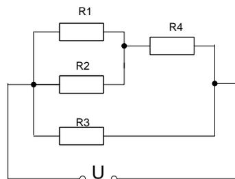
13. У електричного кола порахуйте значення сили струму в резисторах, якщо  $E = 15 \text{ В}$ ,  $R_1 = R_2 = R_3 = 1 \text{ кОм}$ .
