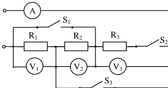
5. Всі резистори в електричному колі однакові і мають опір по 10 Ом. До кола прикладена напруга 120 В. Які вимикачі потрібно ввімкнути, щоб струм протікав тільки по першому та другому резистору? Що при цьому будуть показувати вимірювальні пристрої?
