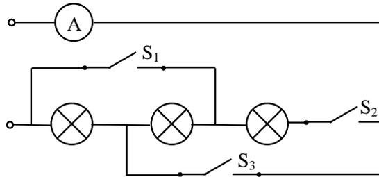
3. До електричного кола прикладена напруга 6,3 В. Кожна лампа споживає струм 0,26 А при 6,3 В. Які вимикачі потрібно ввімкнути, щоб на повну потужність світили всі три лампи? Яку силу струму при цьому покажуть амперметр?
