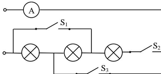
4. Всі резистори в електричному колі однакові і мають опір по 10 Ом. До кола прикладена напруга 120 В. Які вимикачі потрібно ввімкнути, щоб струм протікав тільки по першому резистору? Що при цьому будуть показувати вимірювальні пристрої?
